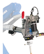
溶接トーチ取付状態と 補正装置
